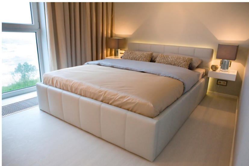
▲ Grzejnik tworzy przed oknami swego rodzaju kurtynę powietrzną, czyli warstwę ogrzanego powietrza. REGULUS-SYSTEM
