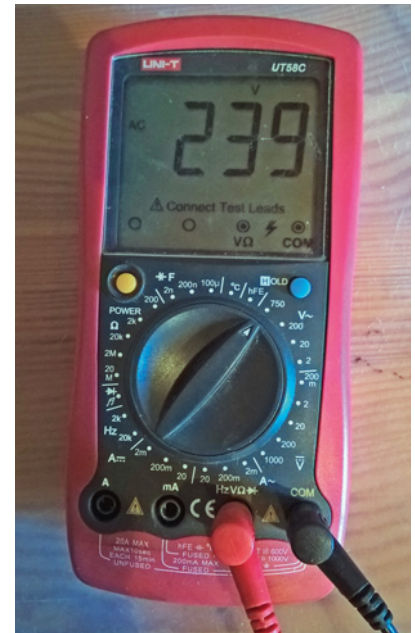
▲ Nominalne napięcie prądu wynosi 230 V. Rzeczywiste nie może zaś być większe niż 253 V. Po przekroczeniu tej wartości falownik nie może już wysyłać energii do sieci. J. ANTKIEWICZ
