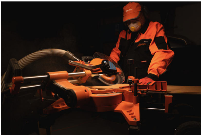
▲ Pilarka akumulatorowa jest łatwiejsza w obsłudze od spalinowej i pozbawiona ograniczenia w postaci kabla podłączonego do sieci. STANLEY BLACK&DECKER
