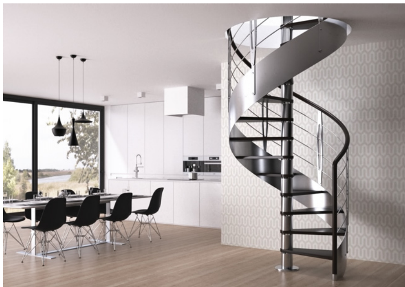
▲ Metal słabo tłumi dźwięki, dlatego biegi w schodach o takiej konstrukcji często wykonane są z innego materiału. RINTAL
