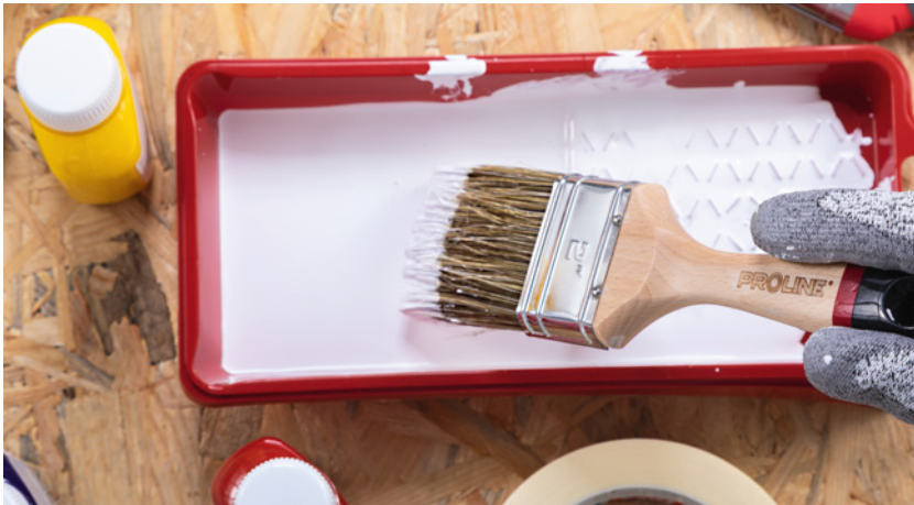
▲ Do malowania ścian i sufitów w pomieszczeniach stosuje się obecnie farby wodorozcieńczalne – prawie bezzapachowe, przyjazne dla środowiska. LAKMA SAT
