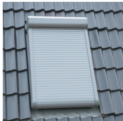
▲ Rolety zewnętrzne wykonane są z aluminiowych lameli. Wysuwają się z umieszczonej nad oknem kasety i poruszają po bocznych prowadnicach. OKPOL
