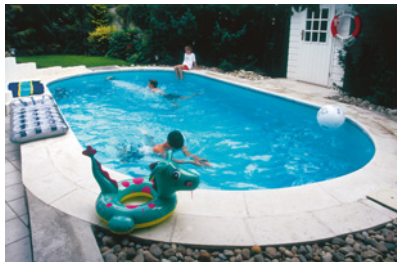
▲ Basen z niecką ze stali, ze ścianami wyłożonymi folią z PVC. BWT
