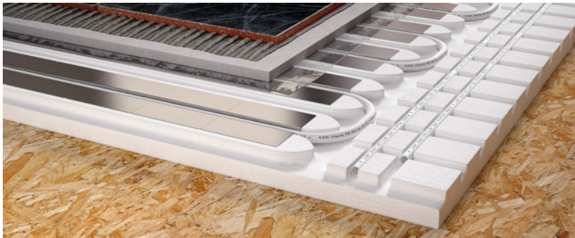
▲ Lekkie warianty podłogówki, z izolacyjnymi płytami systemowymi oraz suchym jastrychem, charakteryzuje dynamika działania zbliżona do grzejników.KAN
