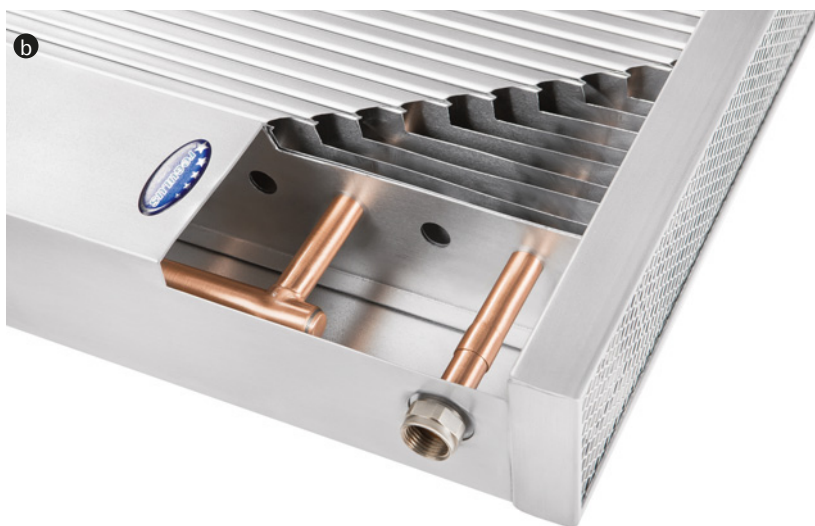
▲ Dekoracyjny grzejnik (a) i jego budowa (b) – układ wodny tworzą tu rury miedziane, a układ oddawania ciepła osadzone na nich lamele z blachy aluminiowej. REGULUS-SYSTEM
