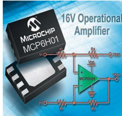
Wykazują bardzo dobre parametry stałoprądowe: maksymalne napięcie niezrównoważenia wynosi 3,5mV, CMRR 100dB, a PS-RR 102dB.
