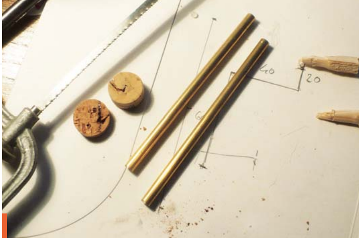
Dwie rurki mosiężne, z których wygniemy dysze turbiny.
